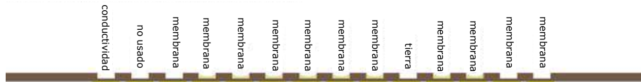
VISTA LATERAL DEL CANAL DEL MÓDULO DE SENSOR DESPUÉS DE IMPRIMIR LA MEMBRANA
